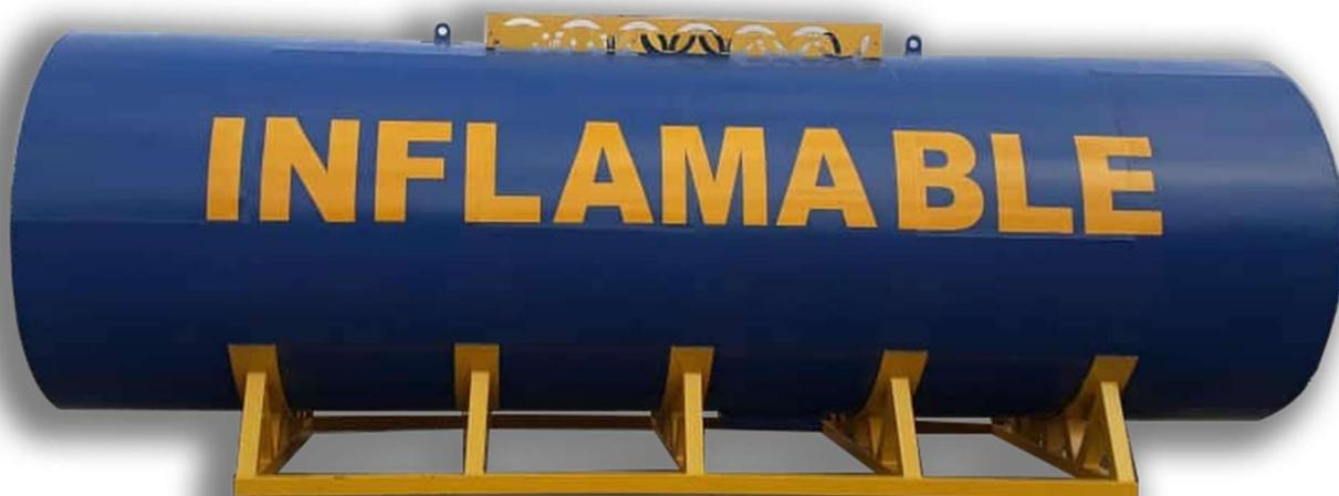
Tanques fabricados en acero al carbono calidad A-36 con espesor de laminas de 3 y 4mm, incluyen trampa de agua inferior, escalera de acceso lateral, boca de registro superior y base en tubo estructural. Ideal para el almacenamiento de los diferentes combustibles existentes, agua, aceites, melaza, entre otros. Presentación de diferentes tamaños y capacidades de almacenamiento según la tabla siguiente:
