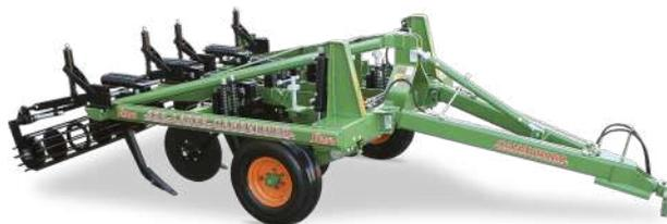
Idóneo para trabajos pesados en plantaciones de caña de azúcar. Hace el subsolado hasta en **62 cm de profundidad**. Los discos son independientes y ajustables, proyectados para el corte de grandes volúmenes de rastrojo.
