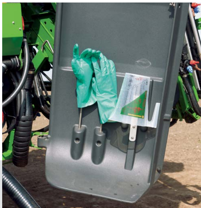
✓ En el interior de la puerta abatible hay soportes para guantes y un vaso de medición
